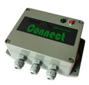
Questo dispositivo è una interfaccia compatibile con il telecomando EnvirOn installabile a muro che permette di attivare applicazioni di controllo ambientale domestico come l'apertura di una porta di una finestra o di una serratura elettrica.
